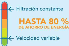
Hacer funcionar una bomba VS al 50% durante 24 horas en lugar de una bomba de encendido / apagado durante 8 horas permite un ahorro de energía de casi el 80%.
