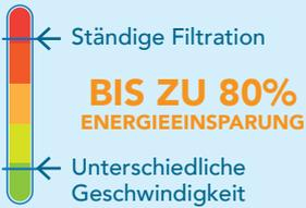
Wenn eine VS-Pumpe 24 Stunden lang mit 50% anstatt 8 Stunden lang mit einer Ein / Aus-Pumpe betrieben wird, können Energieeinsparungen von nahezu 80% erzielt werden.
